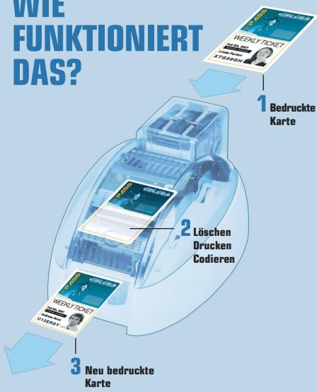
Der **Tattoo RW** arbeitet anstatt mit einem Druckband mit wiederbeschreibbaren Karten. Diese Karten enthalten ein wärmeempfindliches Material, das je nach angewandter Temperatur sichtbar oder unsichtbar wird. Dieser umkehrbare Prozess erlaubt es, eine Karte bis zu 500 Mal immer wieder neu zu bedrucken. So können Sie auf Ihre Karten wechselnde Motive und Angaben aufdrucken, wie etwa Treuepunkte oder Sonderaktionen auf Kundenkarten, oder Namen von Besuchern auf Firmenkarten.
